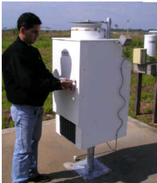
Figura 4. Disposição do amostrador de chuva sobre sua plataforma e suporte de fixação. Na área, também, há um pluviômetro digital para medições da intensidade e da altura das chuvas.
